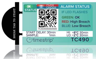
デジタル温度インジケーターTC490は、コールドチェーン2-8°C輸送中に温度逸脱が起こっていたかを簡単に確認できる温度インジケータです。本体に搭載された3色のLEDランプによって、輸送時・保管時の閾値越えの有無を簡単に確認できます。不可逆性で、光が点滅するため一目瞭然と判断できます。温度ロガーはコストが掛かるが、閾値越えの有無を確認したい、温度シールでの管理だけで不明瞭で不安だ、など価格を抑えて2-8°C温度モニタリングを行いたいお客様に最適な温度管理ツールです。
