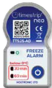
タイムストリップネオTT525-ADは、0°C以下の温度環境にさらされると、LEDランプが点灯し、閾値越えが発生したことを知らせます。2種類のアラームを搭載しており、0°C以下で30分以上経過した際と、0°C以下で60分以上経過した際と各アラームのLEDが点滅します。アラームはいずれも不可逆式で、一度点灯すると元には戻りません。コンパクトで耐久性に優れ、長期間使用できるため、凍結温度管理が必要なあらゆる現場でご利用いただけます。
